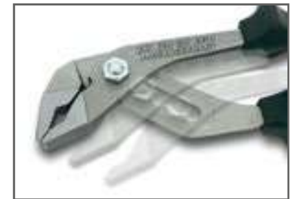
Gleitgelenk slip joint
