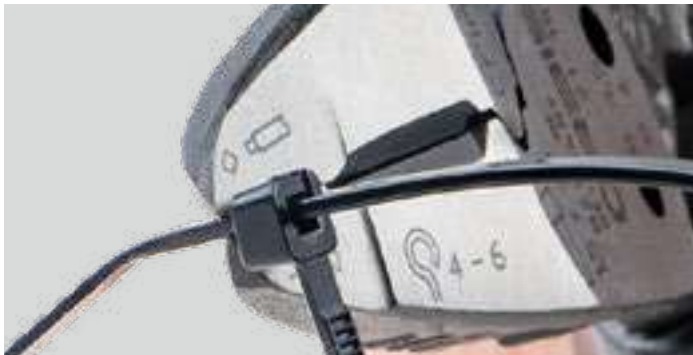
Flatschneider nur für Kabelbinder oder Kupferleiter Accurate flat cutter for cable ties or copper leads
