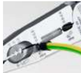
4 Crimpen von Aderendhülsen 4 crimping of ferrules
