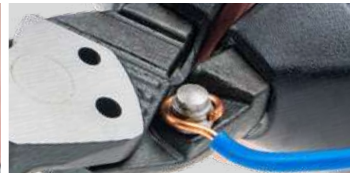
Ösen biegen Ø 4, 5, 6 mm Looping device Ø 4, 5, 6 mm
